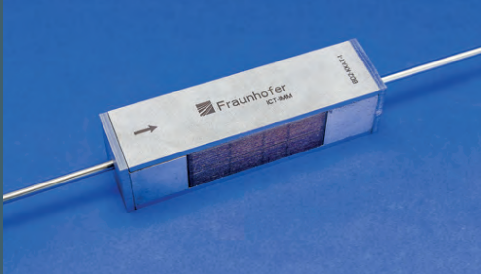
Laserschweißter Mikroreaktor zur Biodiesel-Herstellung
