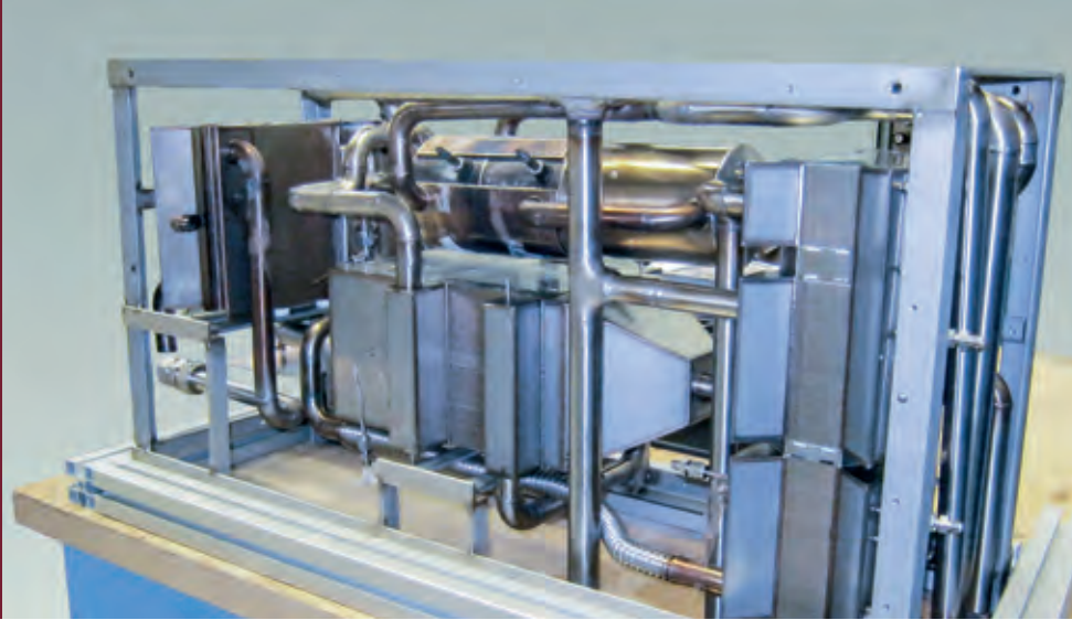
Propylenglykol- Reformersystem zur Energieversorgung von Flugzeugbordküchen
