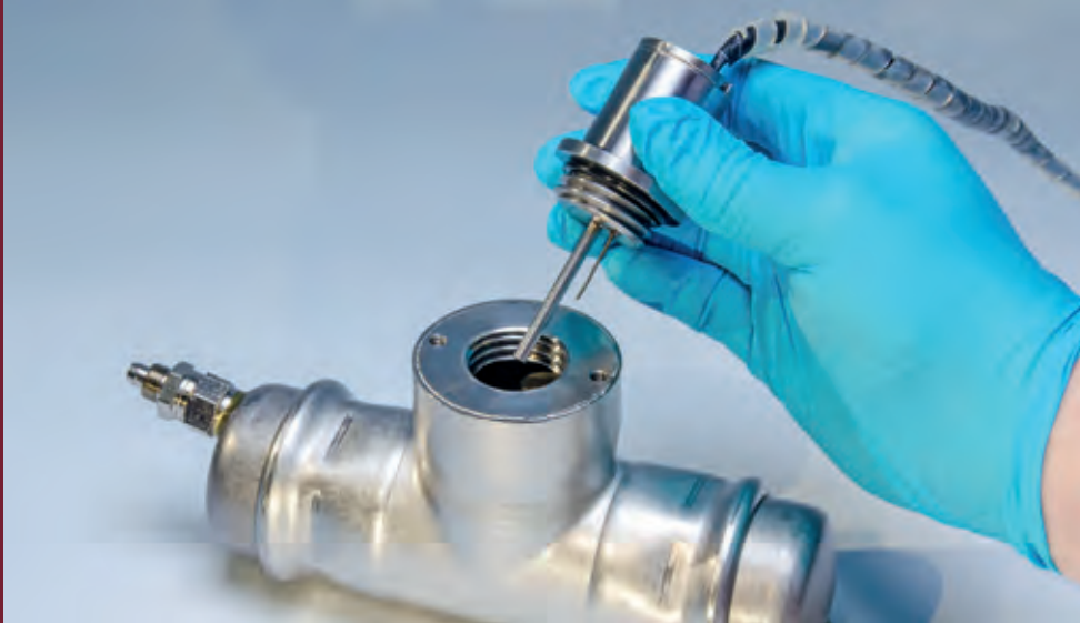
Sensor zur Online- Bestimmung der Viskosität von Schmieröl
