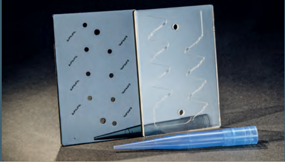
Mikrofluidischer Chip für die Online-Titration
