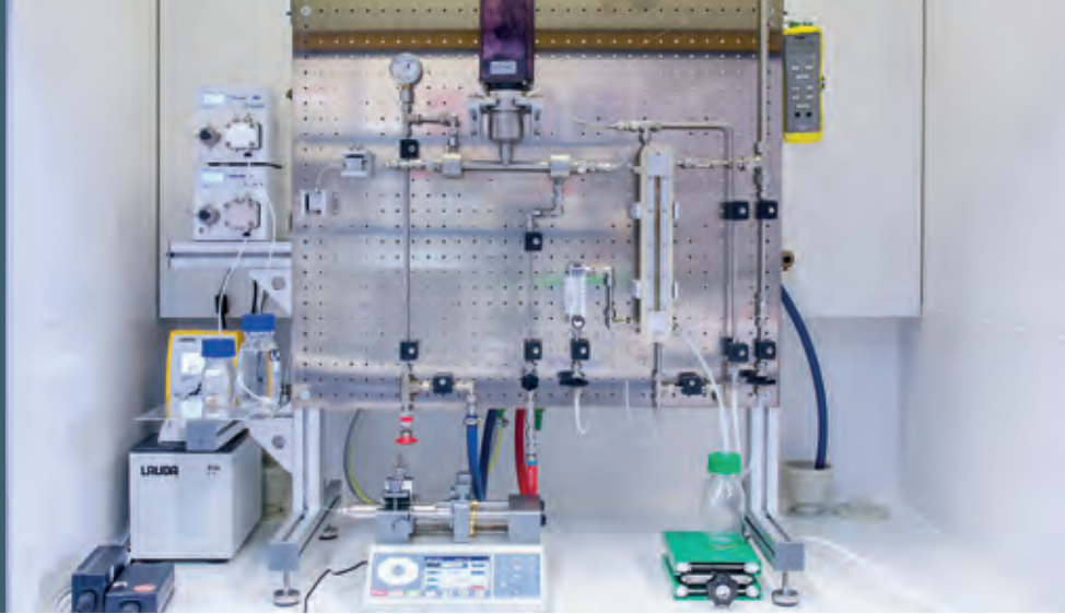
Laboranlage zur Verkapselung von Wirk- oder Aromastoffen
